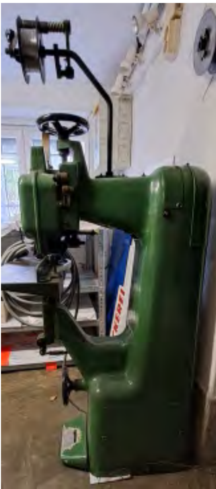
Drehtheftmaschine (Klopfer) Bremer Leipzig Anschaffung 1996 Funktionsfähig
